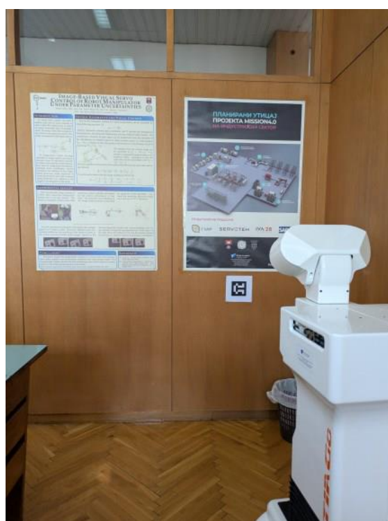
Слика 22. Експериментална поставка и прикупљање података. Мобилни робот PAL TIAGo реализује визуелно серво управљање у затвореном лабораторијском окружењу.
